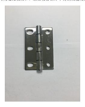
不锈钢铰链由一定位组件,及与一定位组件相配合使用的第二定位组件组成。能实现便捷的组装和拆卸维护作业,保证装配后如门窗,家具门等完成准确,稳定的开合控制,提高了整体结构的实用性,使用寿命长。不锈钢铰链包括安装于固定门上的固定页片,安装于活动门上的活动页片以及同时穿装于固定页片和活动页片中的旋转轴;旋转轴穿装于固定页片中的一侧开设有一限位环槽,旋转轴穿装于活动页片中的一侧开设有第二限位环槽,固定页片的一侧横向穿设有一端嵌入于一限位环槽中的一限位件,活动页片的一侧横向穿设有一端嵌入于第二限位环槽中的第二限位件。减少活动页片与固定页片之间的磨损,从而降低活动门与固定门之间发生高低不平的可能性,保证活动门与固定门之间良好的密封性。重型设备柜体不锈钢铰链规格不锈钢铰链一般可分为3大主体结构组成:铰链头(铁头),本体,底座。
