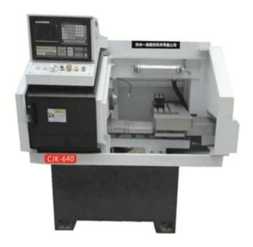
全自动车床使用前的注意事项: 1、工作前按规定穿戴好防护用品,扎好袖口,不准戴围巾、戴手套。女工发辫应挽在帽子内。高速切削时要戴好防护眼镜。2、认真检查机床上的防护、保险、机械传动部分、电气部分防护装置、卡盘是否安全可靠,电器开关和手柄是否在正常位置。3、按机床润滑图表加油,空转试车1—2分钟,查看油窗等部位。4、工夹、刀具及工件必须装夹牢固,夹紧时可用接长套筒。卖仪器网禁止用榔头敲打。滑丝的卡爪不准使用,转换方刀架时应注意卡盘、工件与刀的距离。床头、小刀架、床面、滑道面禁止放工、量具或其它物品。5、加工细长工件要有顶针、跟刀架,车头前面伸出部分不得超过工件直径20倍。车头后边伸出300mm时必须有托架,必要时装设防护栏杆。济南车铣复合数控机床多少钱数控机床对加工对象的适应性强。
