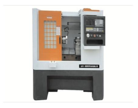
数控机床的中心是数控装置。现代数控装置均采用CNC形式,这种CNC装置一般使用多个微处理器,以程序化的软件形式实现数控功能,因此又称软件数控[CNC系统是一种位置控制系统,它是根据输入数据插补出理想的运动轨迹,然后输出到执行部件加工出所需要的零件。因此,数控装置主要由输入、处理和输出三个基本部分构成。而所有这些工作都由计算机的系统程序进行合理地组织,使整个系统协调地进行工作。将数控指令输入给数控装置,根据程序载体的不同,相应有不同的输入装置。主要有键盘输入、磁盘输入[CAD/CAM系统直接通信方式输入和连接上级计算机的DNC[直接数控)输入。可用纸带光电阅读机读入零件程序,直接控制机床运动,也可以将纸带内容读入存储器,用存储器中储存的零件程序控制机床运动。
